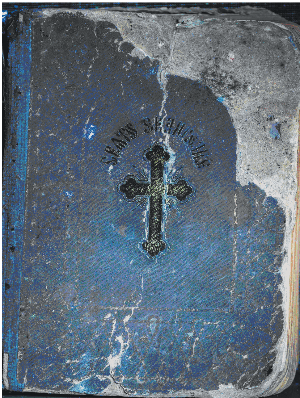
Фиг. 2. Флуоресценция при осветяване с 365 nm ултравиолетова светлина и използван филтър ZBW2, непрпускащ светлина над 365 nm. На снимката ясно се вижда детайл от украса, невидим с просто око под неутрална бяла светлина.
