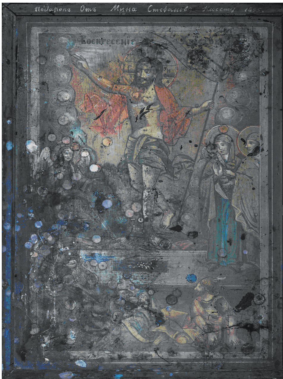
Фиг. 3. Флуоресценция при осветяване с 365 nm ултравиолетова светлина и използван филтър ZBW2, непронускащ светлина над 365 nm. Следи от въсчни петна, деструкция на лаковото покритие и щети от микроорганизми, невидими с просто око, доказващи автентичност
