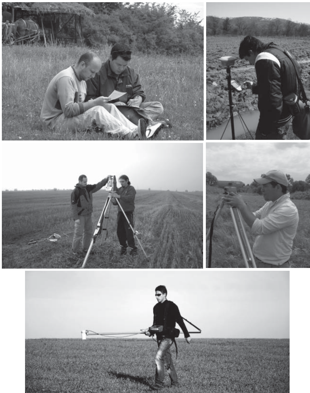
Фиг. 1. Археометрика 2009: Полеви занятия за работа с карти (1), оптичен нивелир (2), тотална станция (3), диференциален GPS (4) и цезиев магнитометър (5).
