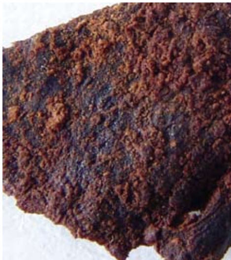
Фиг. 7. Детайл от пробата на фиг.6 след извличане на стипцовото багрило с 3% HCl
