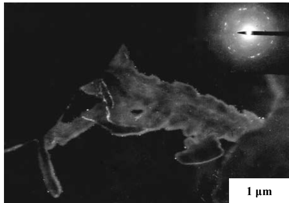
Фиг. 8 TEM изображение в режим DF и картина на електронната дифракция на дендрити в Н.
