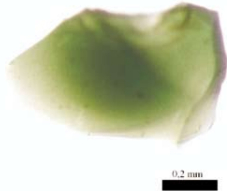
Обр. 6. Експериментално синтезирано стъкло с цел изпитване на рецепта за получаване на стъкло с подобен на изследваните непрозрачни червени стъкла състав – резултатите от този синтез показваха, че независимо от ролята му на редуктор в силикатни стопилки, Sb_2O_3 е в твърде малки количества, за да редуцира достатъчно Si^{2+} йони (отговорни за зеления цвят) до Si^+ състояние, което е необходимо за разтежа на Si_2O кристали и за получаване на червено непрозрачно стъкло.
