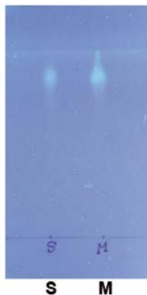
Фиг. 4. TLC хроматограма на субстанцията, извлечена от налепите с абсолютен етилов алкохол (S) и на мастикс (M)
