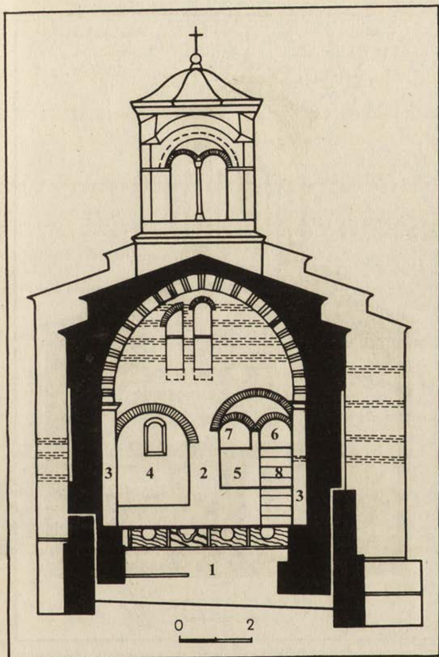
Обр. II. Западна вътрешна стена на Екзонартекса и Западната пристройка - изглед А-А 1 (Е. Дерменджиев)
